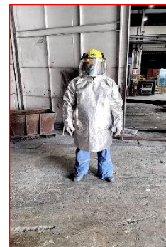
ภาพที่ 2.3-31 พนักงานสวมใส่อุปกรณ์ ป้องกันความร้อน และขนาดพ่น Flux
